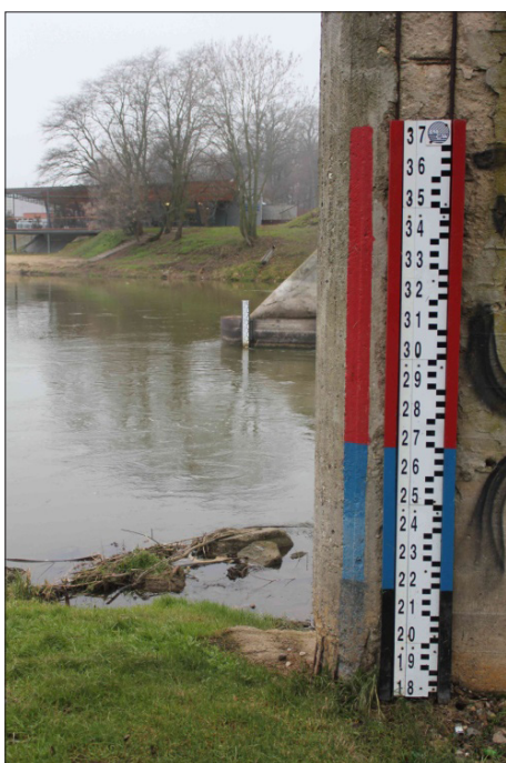
Fot. 3. Obecna lokalizacja posterunku wodowskazowego i miejsca obserwacji zjawisk lodowych. Na pierwszym planie widoczna łata wodowskazowa zamocowana na podporze mostu pieszego. Służy do pomiaru stanów wysokich po wystąpieniu Warty z koryta. W środkowej części koryta widoczna łata wodowskazowa służąca do rejestrowania stanów średnich i niskich (fot. M. Gorączko)
